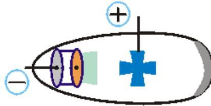
La luminosidad producida por los rayos catódicos siempre se produce en la pared del tubo situada frente al cátodo.
