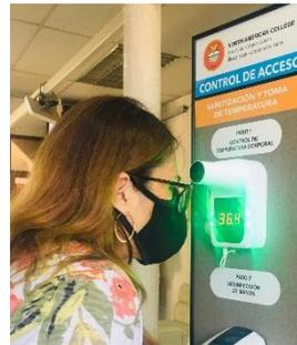
3. Si su temperatura es mayor a la configurada en el equipo (37,8), sonará una alarma intermitente y la temperatura se mostrará parpadeante en la pantalla LED.
